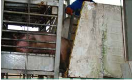
Figura 15. Formação de vão entre o compartimento de carga e a rampa de desembarque, podendo ocasionar ferimentos (fraturas e contusões nas patas) durante a passagem dos suínos.
